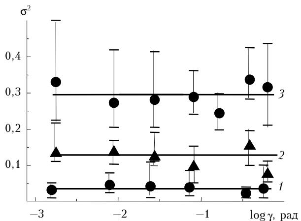
Так как угол поля зрения приемника в снегопадах всегда больше дифракционного угла, то в обоих пучках в наших измерениях мы не установили влияния угла поля зрения приемника на измеренную дисперсию. Эта зависимость отсутствует и без осадков. Вклад аэрозольного рассеяния в этом случае мал.
