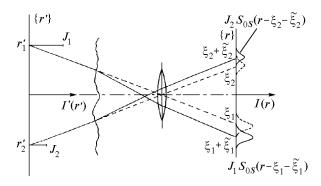
Рис. 2. Схема алгоритма построения реализации  $\widetilde{I}(\mathbf{r})$  коротко-экспозиционного изображения на примере объекта из двух точек:  $\mathbf{r}_1'$ ,  $\mathbf{r}_2'$  – координаты точек в плоскости объекта;  $J_1, J_2$  – их мощности излучения;  $\xi_1$ ,  $\xi_2$  – геометрооптические смещения точек в плоскости изображения
