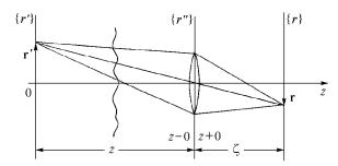
Рис. 1. Модель переноса изображения в турбулентной атмосфере:  $\mathbf{r}'$  – координата точечного источника в плоскости объекта  $\{\mathbf{r}'\}$ ;  $\mathbf{r}''$  – координата в плоскости линзы;  $\mathbf{r}$  – координата в плоскости изображения  $\{\mathbf{r}\}$ ; z – расстояние от плоскости объекта  $\{\mathbf{r}'\}$  до линзы;  $\zeta$  – расстояние от плоскости изображения  $\{\mathbf{r}\}$  до линзы;  $\zeta \approx f$  при  $f \ll z$ , где f – фокусное расстояние линзы
