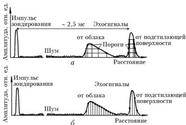
Рис. 1. Принципы регистрации эхосигналов от облаков и подстилающей поверхности: а – по пороговому принципу; б – с помощью блока АЦП. Точки на сигналах – местоположение измеренных амплитуд и временных интервалов
