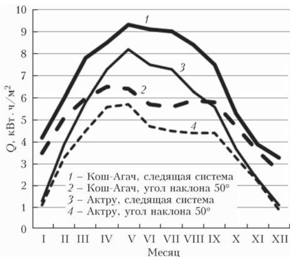
Рис. 2. Средние суточные суммы суммарной солнечной радиации, приходящие на различно ориентированные поверхности, на станциях Кош-Агач и Актру
