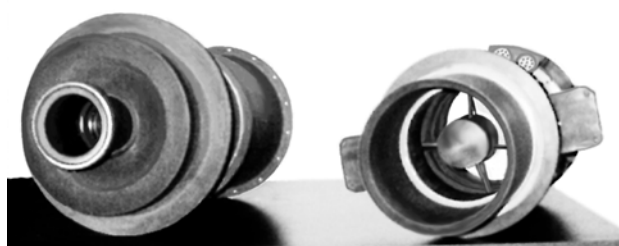
Рис. 4. Фотография телескопов системы обнаружения малых тел: слева – телескоп системы Боуэна, справа – телескоп системы Ричи-Кретьена
