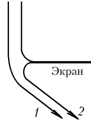
Рис. 4. Схема формирования результирующего потока краевого света, распространяющегося в тень экрана
