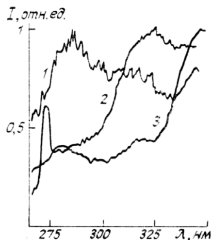
Рис. 2. Спектры люминесценции сырой нефти из района Каспийского моря (1, 3) и бензина (2) в диапазоне длин волн 260 ... 350 нм, нормированные на максимум
