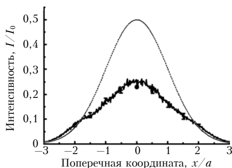
Рис. 5. Усредненный профиль интенсивности лазерного пучка радиусом 2,5 мм при рассеянии в слоисто-кучевом облаке
