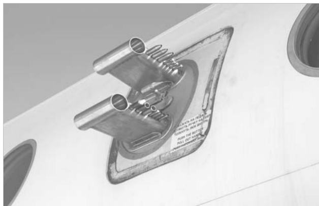
Рис. 4. Заборники воздуха на обшивке Ту-134
