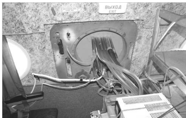
Рис. 5. Разводка воздуховодов внутри самолета
