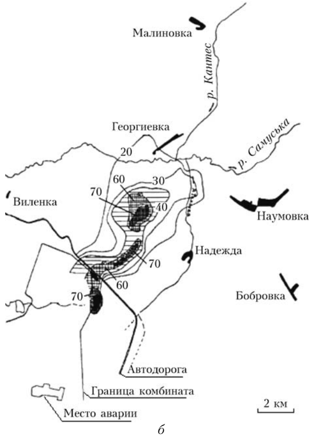
Рис. 1. Карты следов радиоактивных выпадений: a – загрязнение почвы от аварии в Томске-7 по состоянию на 13 мая 1993 г. (мкР/ч); б – загрязнения почвы на 13 июня 1993 г. (мкР/ч)
