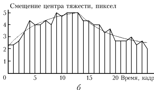
Рис. 2. Пример результата работы программы по аппроксимации экспериментальных данных и вычислению вязкоупругих характеристик: a - \alpha_c = 7,3 \cdot 10^{-15} м 3 , F_{\text{эл}} = 10^{-10} Н, c = 3,1 \cdot 10^{-5} Н/м, \eta_c = 6,8 \cdot 10^{-1} Па · с; b - \alpha_c = 9,3 \cdot 10^{-15} м 3 , F_{\text{эл}} = 1,5 \cdot 10^{-10} Н, c = 4,6 \cdot 10^{-5} Н/м, \eta_c = 1,3 Па · с
