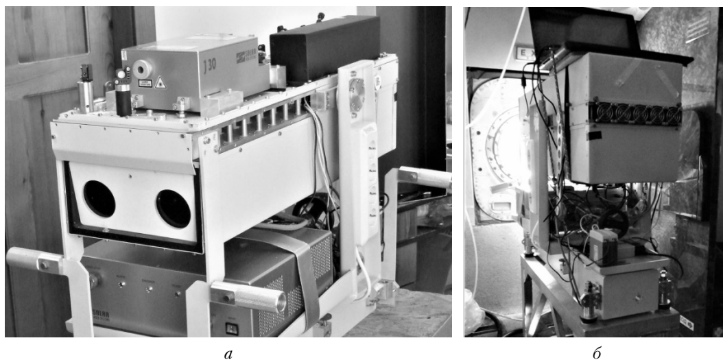
Рис. 2. Лидар УОР-5 в помещении (а) и на борту самолета-лаборатории Ту-134 «Оптик» (б)
