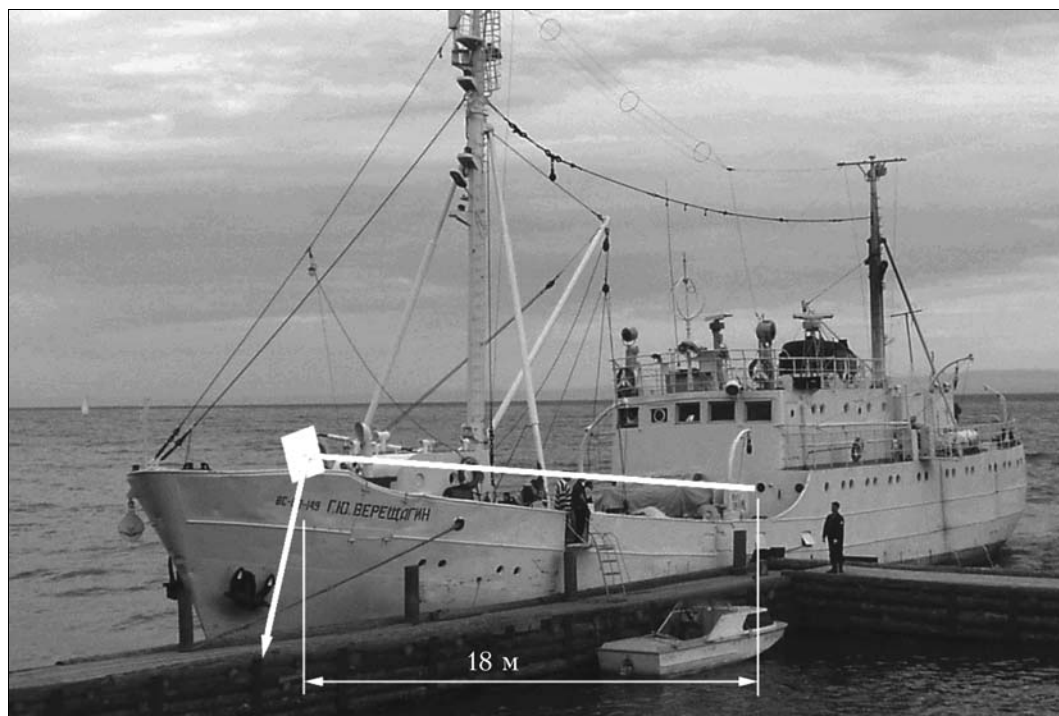
Рис. 2. Размещение лидара на НИС. Белая линия показывает ход лазерного пучка над палубой судна
