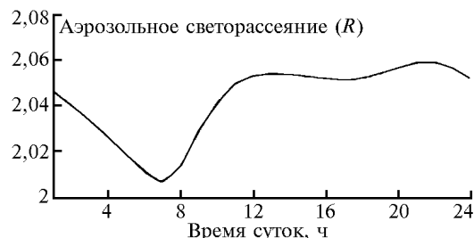
Рис. 2. Установившийся среднесуточный ход оптического рассеяния. R — отношение аэрозольного светорассеяния к молекулярному
