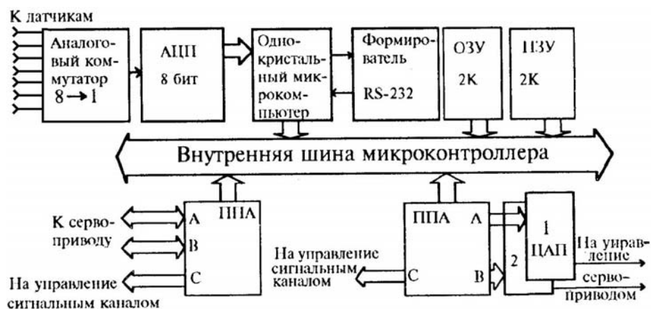
Рис. 3. Структурная схема микроконтроллера управления аэрозольным лидаром
