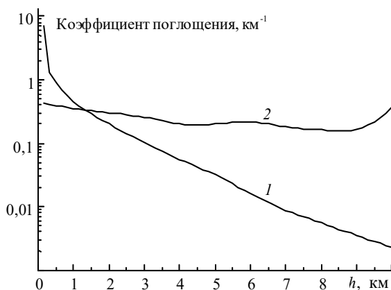
Рис. 4. Вертикальный профиль эффективного коэффициента молекулярного поглощения при распространении многочастотного излучения HF-лазера: 1 – трасса снизу вверх (0–10 км), 2 – трасса сверху вниз (10–0 км). Метеомодель – лето, средние широты
