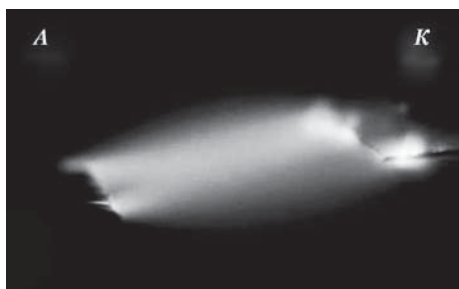
Рис. 6. Интегральная фотография свечения разряда в смеси Ag–Xe. К – потенциальный ножевой катод длиной 30 мм; А – заземленный ножевой анод длиной 50 мм. Давление смеси 400 мбар. Содержание ксенона 1%. d = 10 мм
