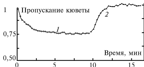
Рис. 2. Пропускание кюветы РГА при продувке ее озono-воздушной смесью от генератора (1) и воздухом (2). За единицу принято пропускание заполненной воздухом кюветы. Продувка воздухом начиналась после установления максимального поглощения озonoвой смесью
