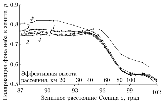
Рис. 4. Зависимость поляризации фона безлунного утреннего сумеречного неба в зените от зенитного расстояния Солнца в декабре 2007 – январе 2008 г. (1 – 9 декабря 2007, 525 нм; 2 – 10 января 2008, 525 нм; 3 – 13 января 2008, 513 нм; 4 – 14 января 2008, 513 нм; 4' – 14 января 2008, 684 нм; 5 – 15 января 2008 г., 513 нм)
