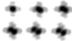
Рис. 7. Динамика распределения интенсивности в фокусе субапертуры гартмановского датчика при появлении дислокации в опорном пучке
