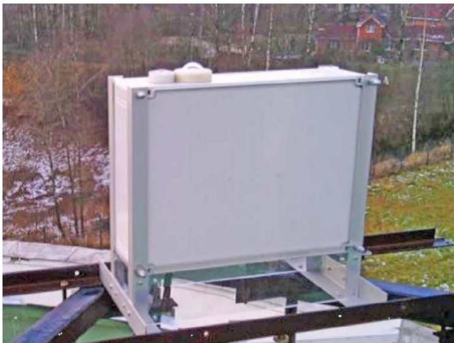
Рис. 3. Ультрафиолетовый озонный спектрометр УФОС на измерительной площадке экспериментальной полевой базы Главной геофизической обсерватории им. А.И. Воейкова ст. Воейково около г. Санкт-Петербурга
