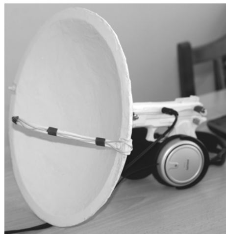
Рис. 7. Направленный микрофон с параболическим зеркалом диаметром 32 см
