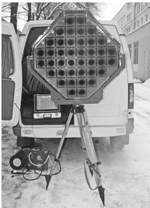
Рис. 6. Внешний вид мобильной излучающей системы акустического стенда в развернутом положении
