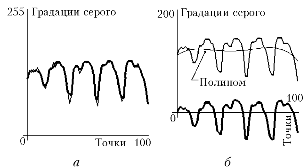
Рис. 3. Медианная (а) и полиномиальная (б) фильтрации: — — до фильтрации; — — после фильтрации
