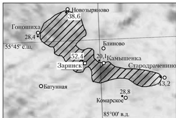
Рис. 6. Зона загрязнения снежного покрова (заштрихованная область) в районе расположения г. Заринска по данным спектрорадиометра MODIS. Численные значения – поверхностная плотность загрязнения снега ( \text{г}/\text{м}^2 ) по данным наземных наблюдений
