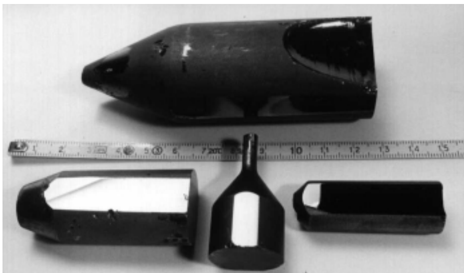
Рис. 4. Монокристаллы ZnGeP_2 , выращенные методом Бриджмена (вертикальный вариант) на затравке с разной ориентацией: [116], [132], [102] и [100]
