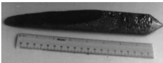
Рис. 3. Поликристаллический слиток соединения ZnGeP_2 , синтезированного в ИОМ СО РАН. Масса загрузки – 415 г
