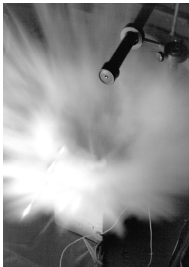
Рис. 4. Схема (а) и общий вид (б) экспериментальной установки: L — лазер; 1 — защитная трубка; 2 — границы аэрозольного облака; dS — площадка, на которую приходит рассеянное под различными углами излучение; l_S — длина оптического пути без использования защитной трубки; l'_S — длина оптического пути с использованием защитной трубки
