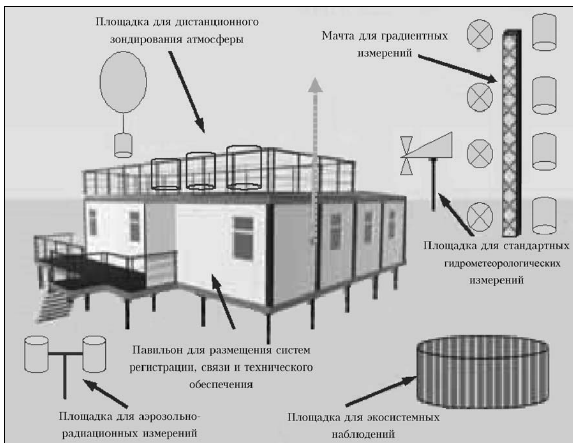
Рис. 1. Структура типового пункта наблюдений региональной сети мониторинга природно-климатических изменений
