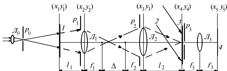
Рис. 1. Оптическая схема записи и восстановления двухэкспозиционной голограммы Фурье: 1 – матовый экран; 2 – опорный пучок; 3 – фотопластинка-голограмма; 4 – плоскость регистрации интерферограммы,  $L_0, L_1, L_2, L_3$  – линзы,  $p_0, p_3$  – фильтрующие диафрагмы,  $p_1, p_2$  – апертурные диафрагмы
