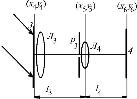
Рис. 2. Оптическая схема регистрации интерферограммы, локализующейся в плоскости голограммы
