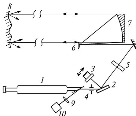
Перестраиваемый  $\text{CO}_2$ -лазер, состоящий из активного элемента типа ГЛ–501 1, дифракционной решетки 2 и перестроечного зеркала 3, диафрагмы 4, имеет на выходе излучение с линейной поляризацией, благодаря наличию окна под углом Брюстера в активном элементе
